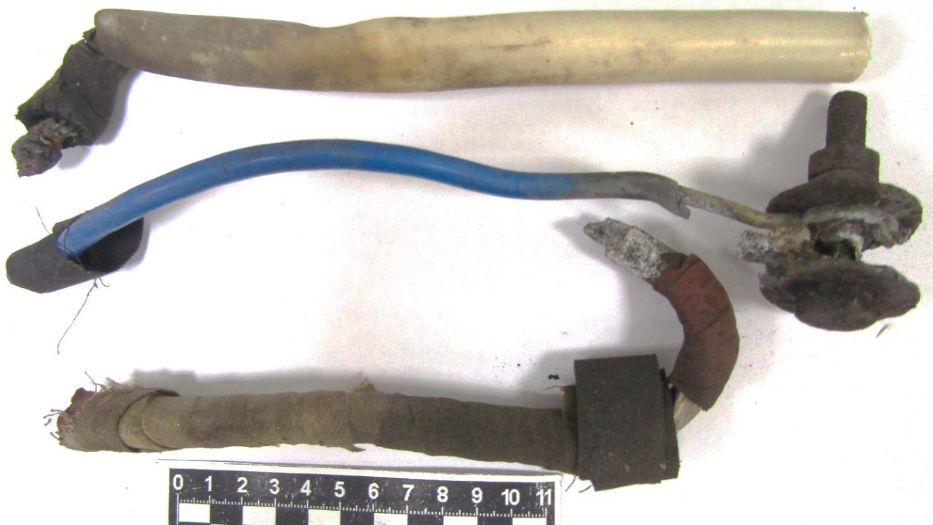
Рис. 1 – Объект исследования - болтовое соединение медного проводника и алюминиевого кабеля
