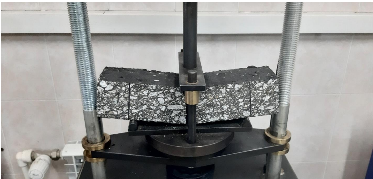
Рис. 4 – Проведение испытаний на изгиб при температуре (минус 18\pm 2 ) °С
