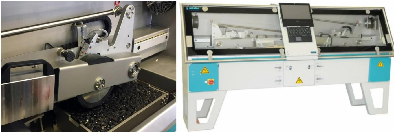
Рис. 1 – Испытание покрытия на колееобразование в установке
