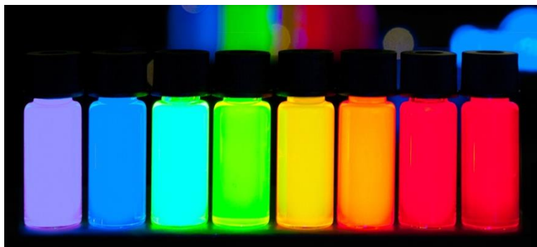
Рис. 1 – Люминофоры на коллоидных квантовых точках перекрывают весь спектр видимого света
