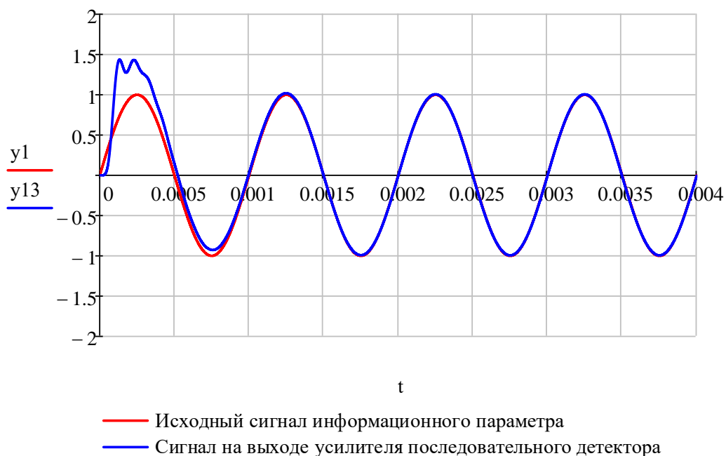
Рис. 16 – Сравнение исходного информационного процесса ( y_1 ) и сигнала на выходе усилителя y_{13} (коэффициент усиления K = 1 \text{ [В]} / U_{\max} \text{ [В]} = 1,471 )
