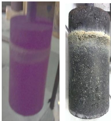
Рис. 4 – Тестируемый образец анода после 12 часовой выдержки в электролите
