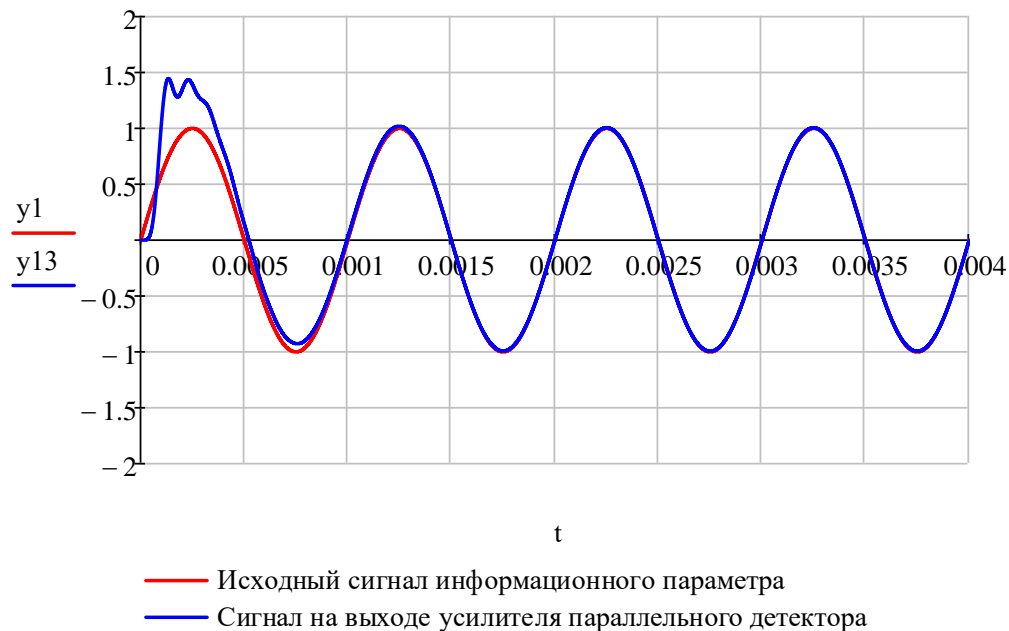
Рис. 21 – Сравнение исходного информационного процесса ( y_1 ) и сигнала на выходе усилителя y_{13} (коэффициент усиления K = 1 \text{ [B]} / U_{\max} \text{ [B]} = 1,471 )
