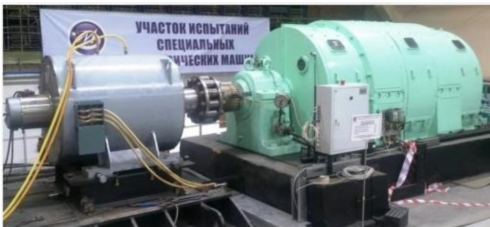
Рис. 3 – Первый в мире синхронный ветрогенератор мощностью 1 МВ·А с обмотками из ВТСП второго поколения
