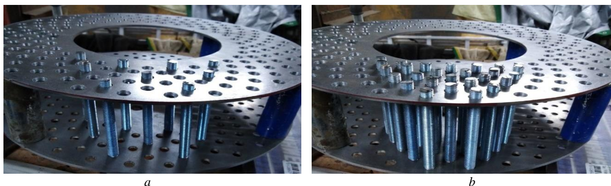
Рис. 1 – Экспериментальный образец агрегата для скарификации семян многолетних трав:
