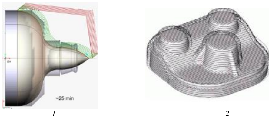
Рис. 6 – Контроль обработки деталей на станках с ЧПУ: 1 – процесс обработки на токарном станке; 2 – процесс обработки на сверлильно-фрезерном станке
