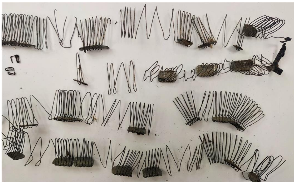
Рис. 4 – Фото фрагментированных частей нагревательной спирали
