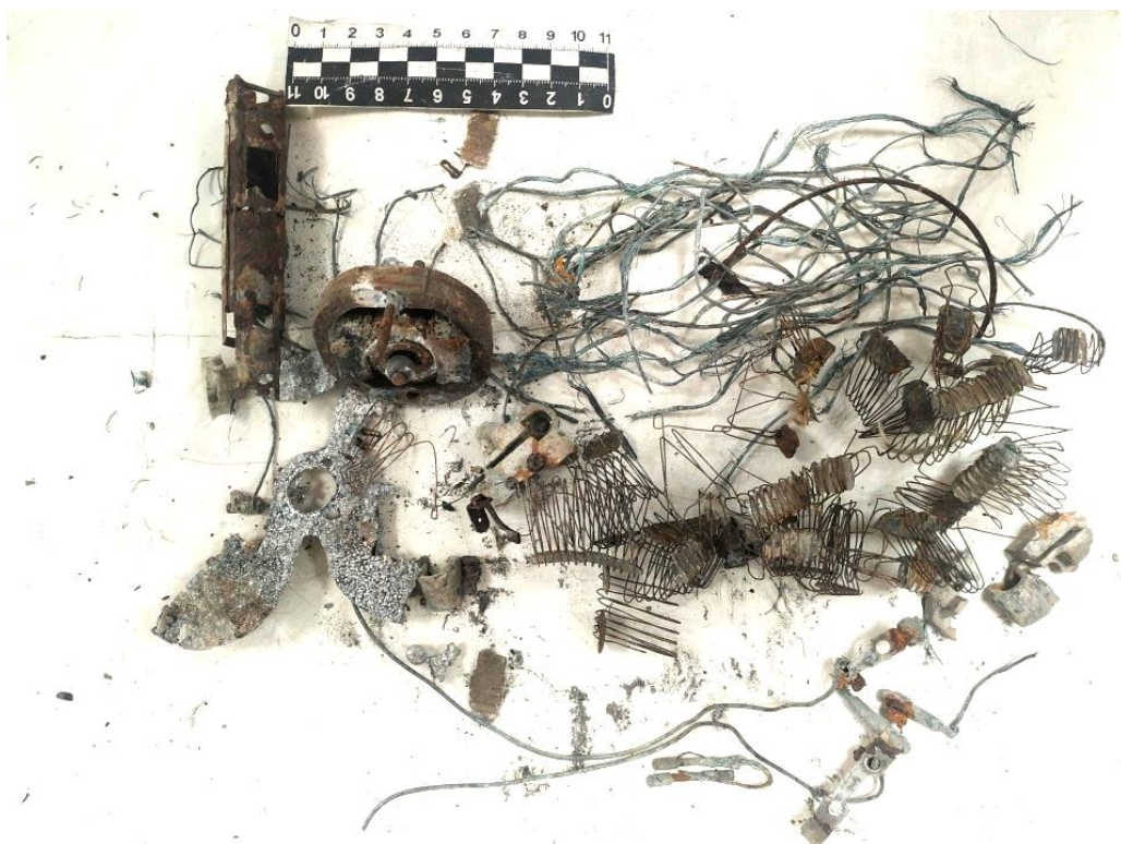
Рис. 2 – Фото остатков тепловентилятора (объекта №1), изъятых с места пожара
