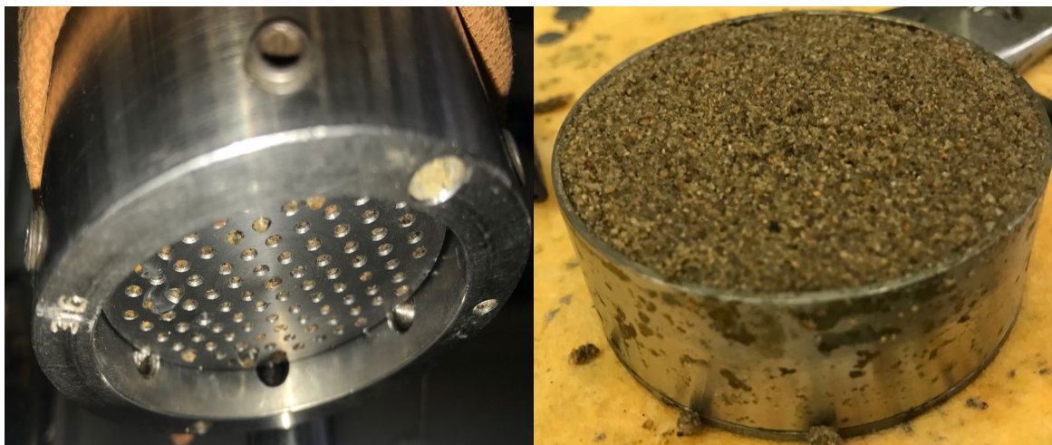
Рис. 2 – Песчаная модель горной породы, помещенная в фильтр-пресс до испытания
