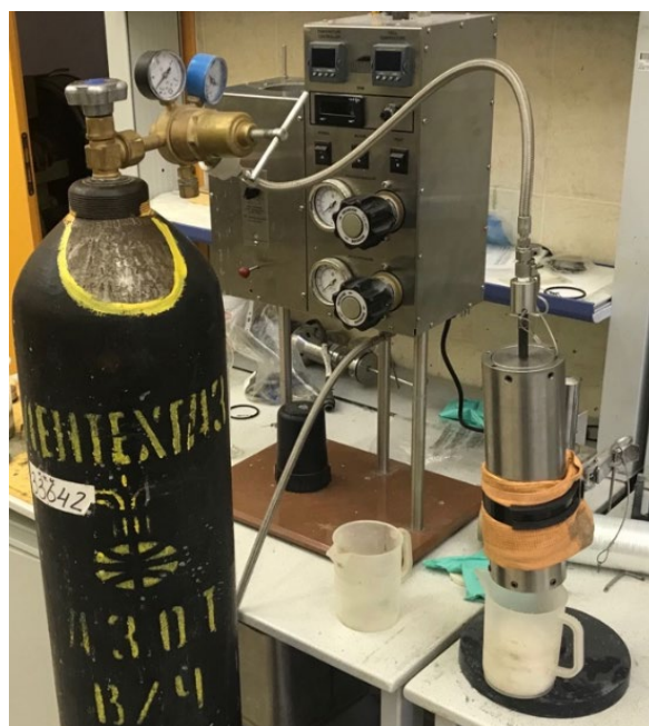
Рис. 1 – Колба фильтр-пресса высокого давления OFITE с раствором и утрамбованным песком
