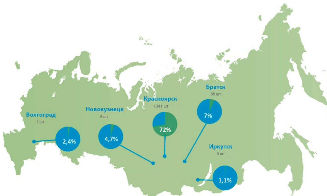
Рис. 4 – Процент электролизеров с системой ЭкоСодерберг на заводах РУСАЛа от общего числа на 2019 год [5]
