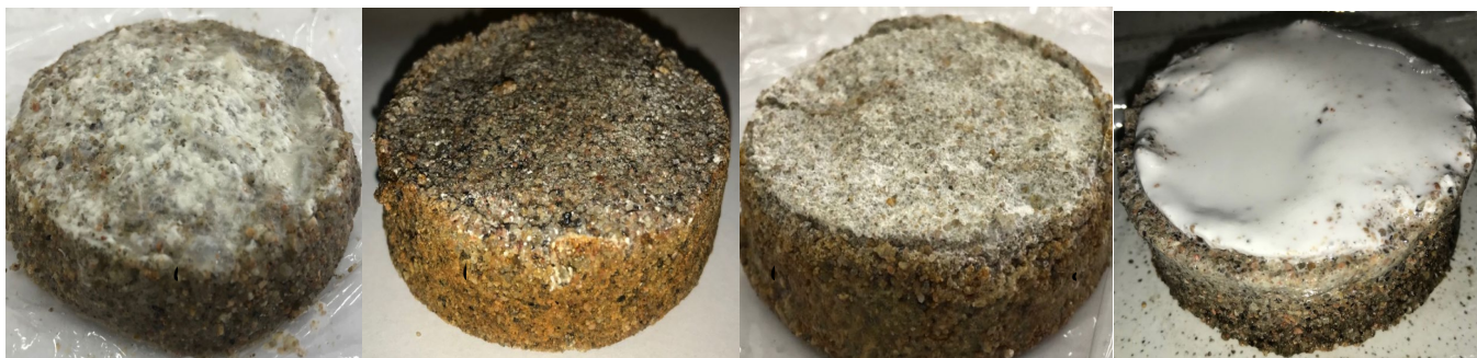
Рис. 5 – Модели горной породы после фильтрации раствором с разной фракцией мела: МК-5 (а), МК-10 (б), МК-50 (в), МК-100 (г).
