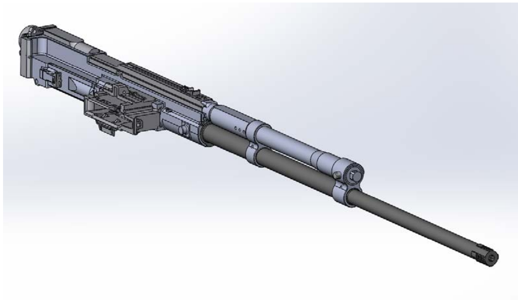
Рис. 2 – Внешний вид 3D модели механизма пулемёта в SolidWorks после исключения элементов, не участвующих в исследовании
