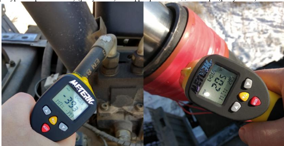
Рис. 6 – Рабочие моменты эксперимента (температурные замеры лазерным пирометром)
