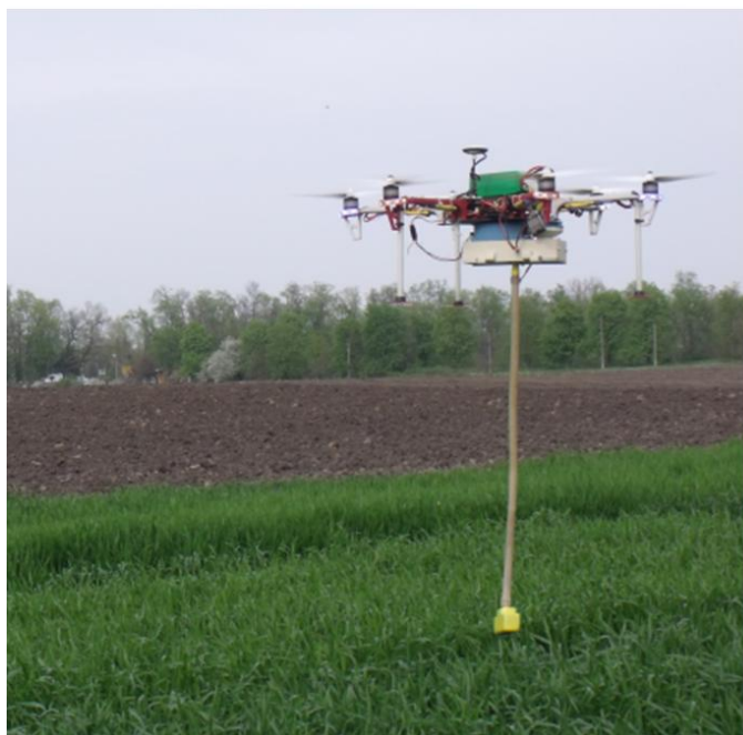
Рис. 1 – Мультикоптер с пробоотборником во время отбора проб
