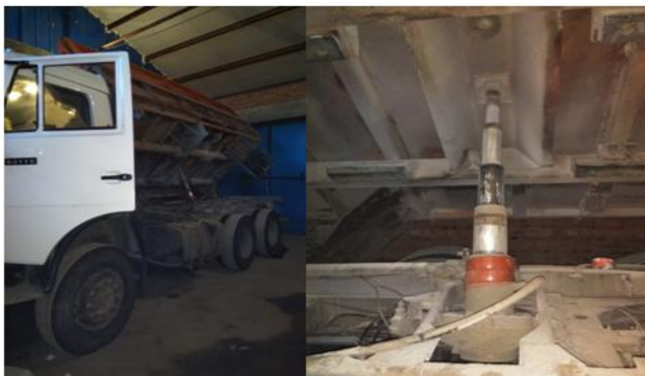
Рис. 5 – Автомобиль КамАЗ с ленточным подогревателем гидроцилиндра
