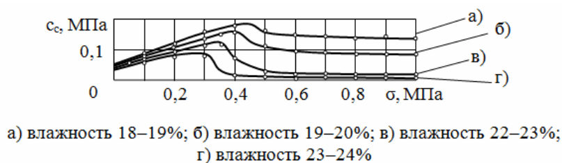
Рис. 2. График зависимости структурного сцепления чеганских выветренных глин от нормальной нагрузки
