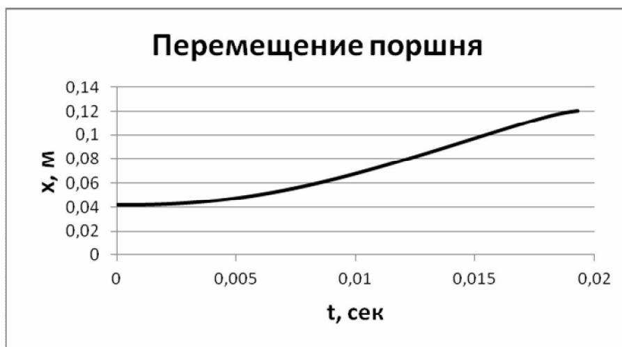
Рис. 3 Зависимость перемещение поршня от времени.
