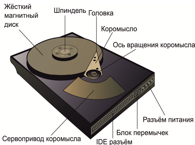
Рис. 1. Структурная схема накопителя HDD
