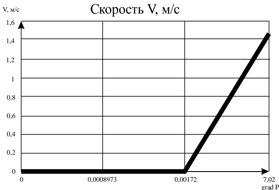
Рис. 2 – Графическая зависимость скорости фильтрации от градиента давления для Доброго месторождения
