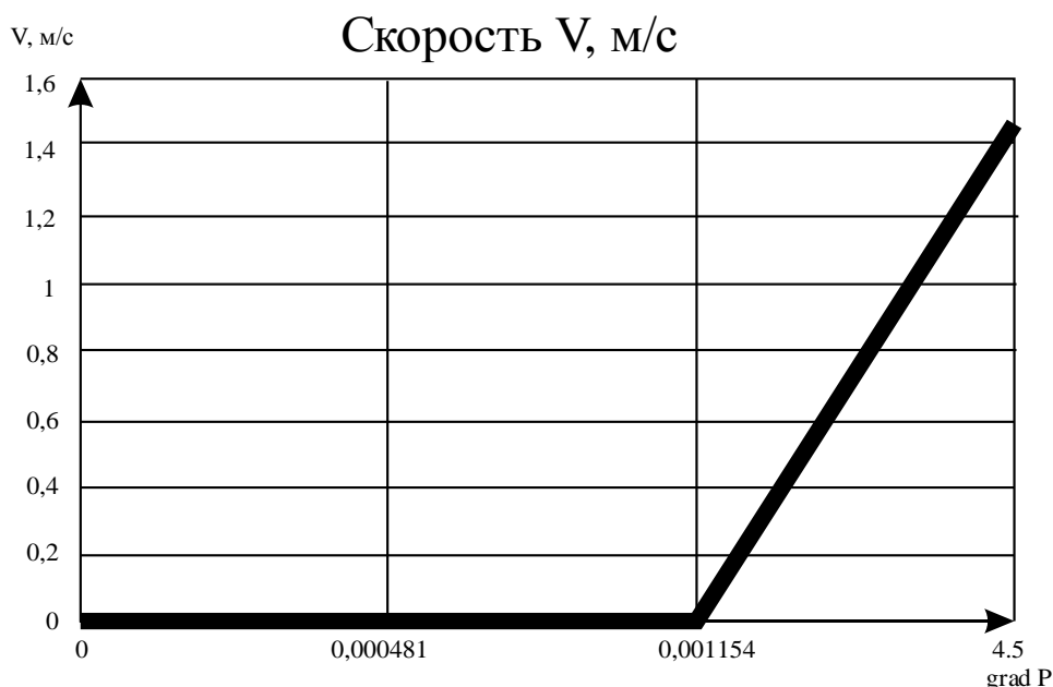
Рис. 3 – Графическая зависимость скорости фильтрации от градиента давления для Авиловского месторождения.
