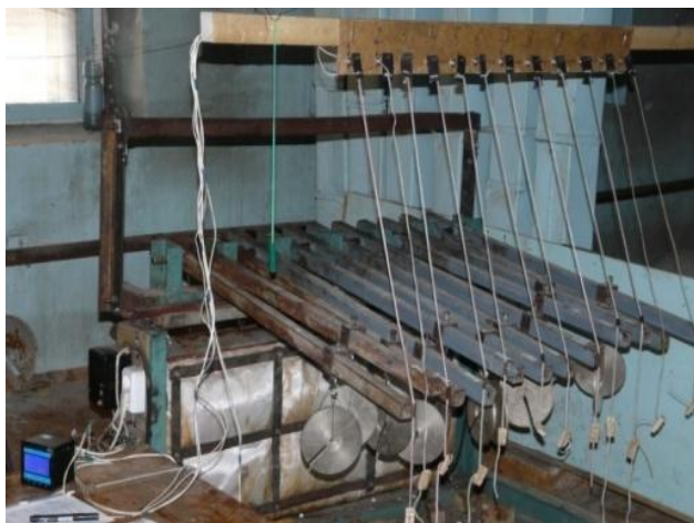
Рис. 1 – Устройство для испытаний на длительное растяжение
