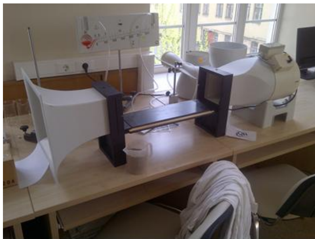
Рис. 1 – Установка для определения массопереноса (Аэродинамическая труба Вентури)
