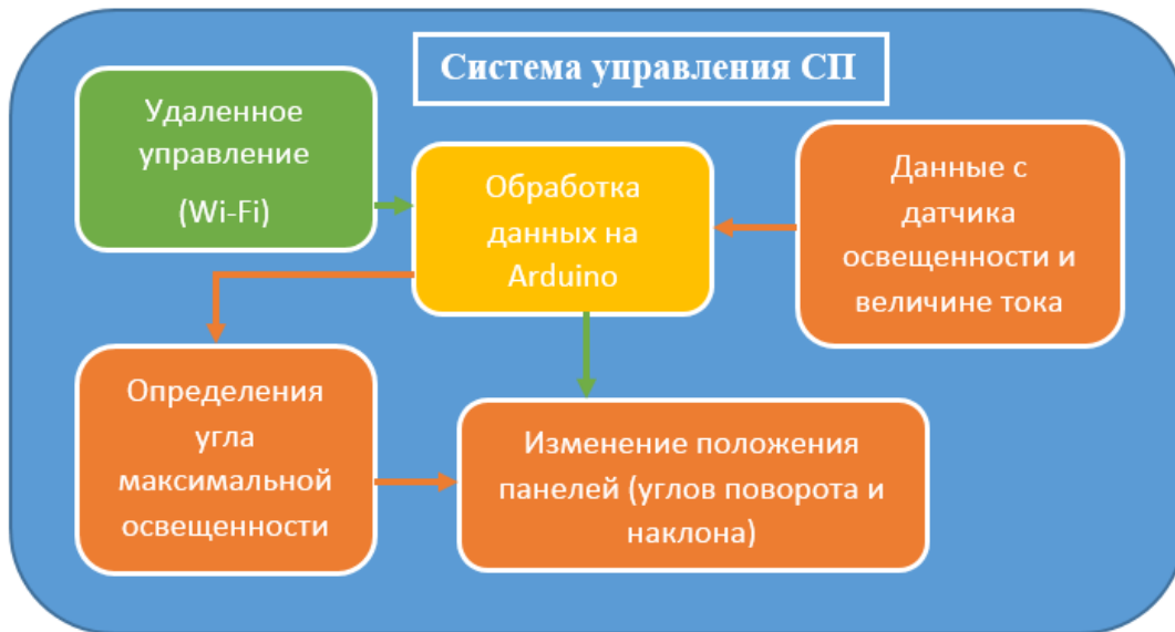
Рис. 6 – Схема работы солнечной панели «Гелиотропическая панель» на лепестковой подложке
