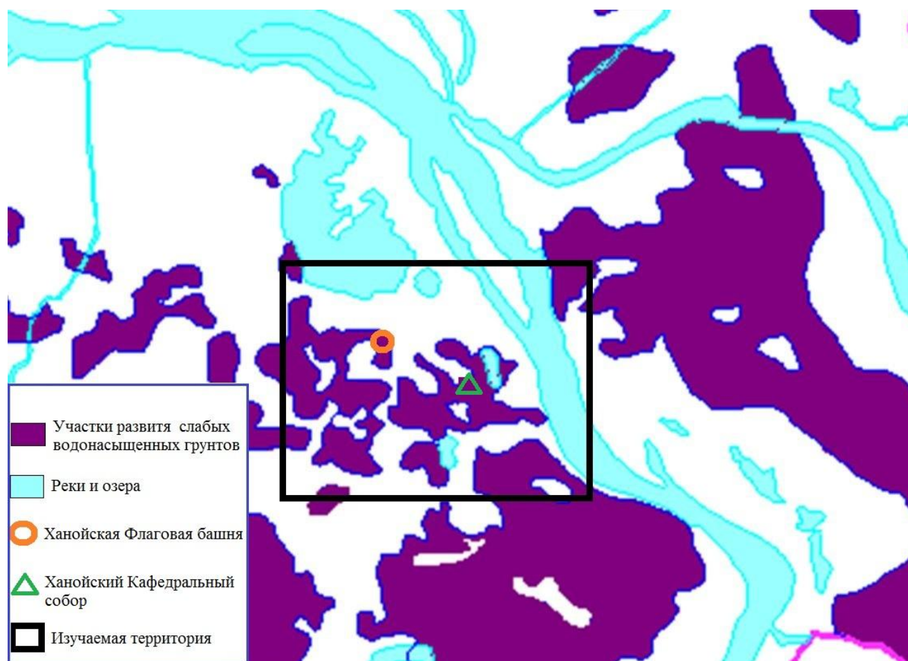
Рис. 3 – Схема распространения слабых водонасыщенных грунтов свиты Хайхынг ( lbIV^{1-2}hh_1 ) [2]
