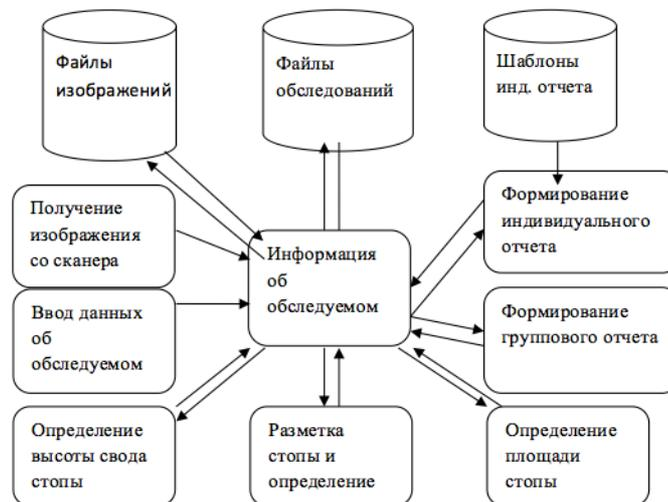
Рис. 1 – Функциональная структура программно-информационного комплекса
