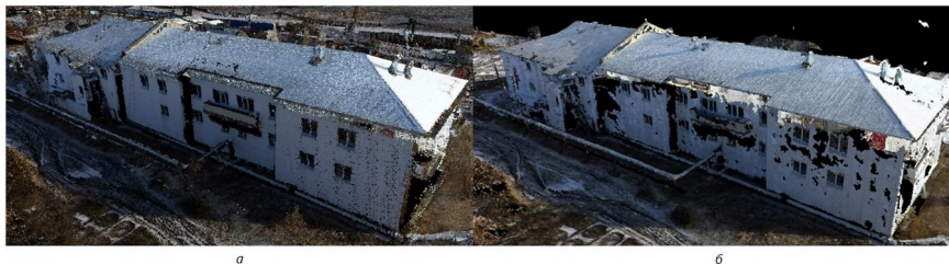
Рисунок 6 - Визуальное сравнение качества облака точек: а - облако точек лазерного сканирования; б - облако точек, построенное по аэрофотоснимкам DOI: https://doi.org/10.23670/IRJ.2023.138.79.8
