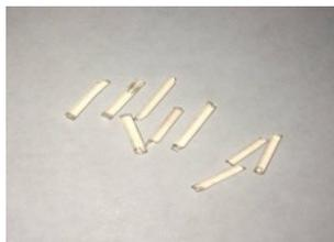
Рисунок 1 - Внешний вид навесок филамента для проведения испытаний
