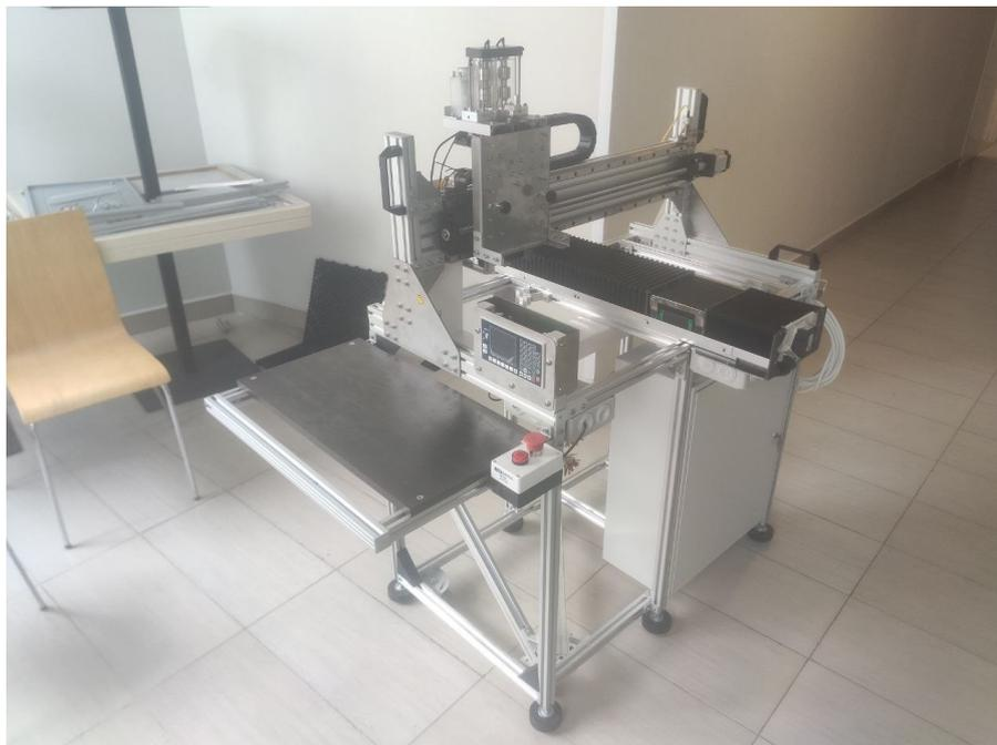
Рисунок 3 - Устройство настройки печатающих головок
