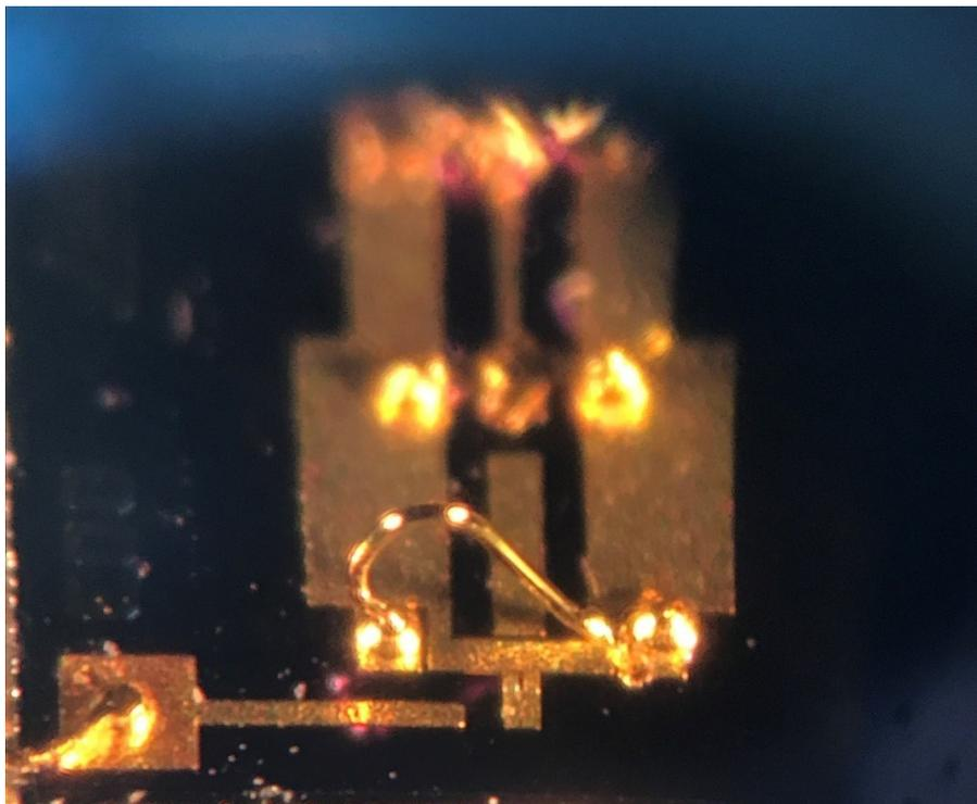
Рисунок 6 - Микрофотография разваренного соединения типа «шарик - клин» с дополнительным шариковым соединением на контактной площадке кристалла
