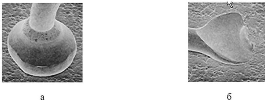
Рисунок 2 - Виды сварки: а) шариком, б) клином [3]
