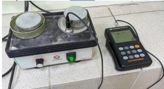
Рисунок 2 - Суглинистый грунт на вибростоле перед пенетрационным испытанием DOI: https://doi.org/10.23670/IRJ.2024.139.35.4
