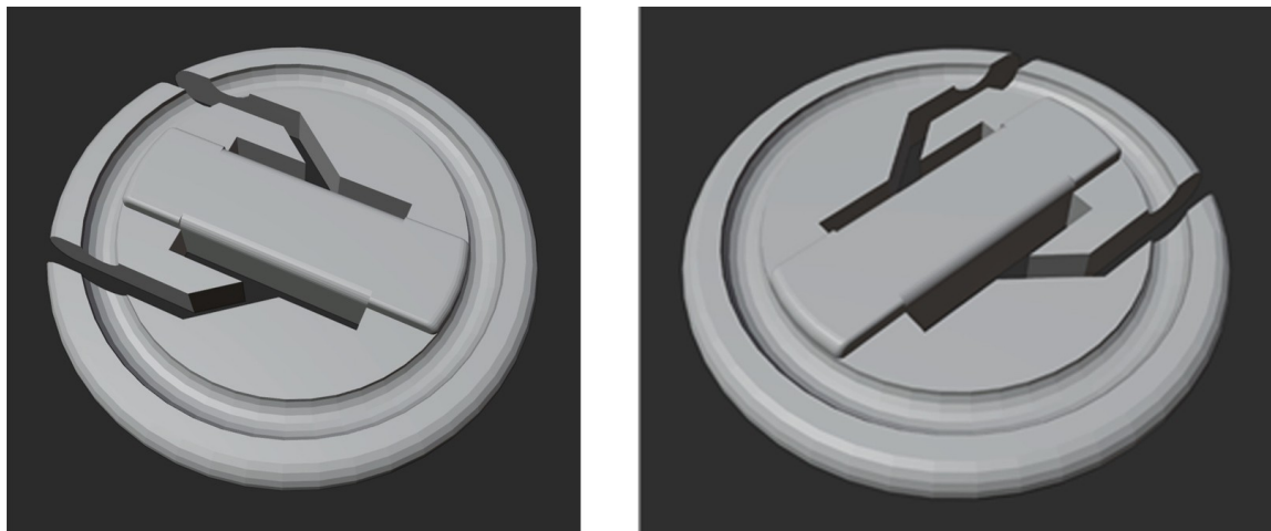
Рисунок 5 - Виды трехмерной модели универсальной двухщелевой пуговицы
