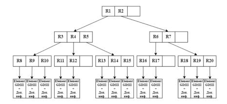
Рисунок 3 - Структура R\*-древа построенная по топологии ИС на рисунке 2 DOI: https://doi.org/10.23670/IRJ.2024.139.26.3
