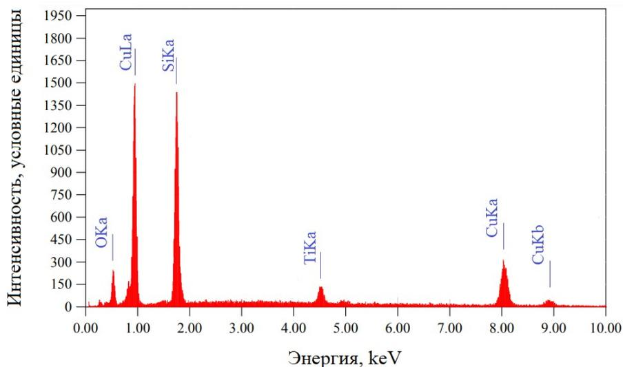
Рисунок 2 - Энергодисперсионный рентгеновский спектр диэлектрического слоя, осажденного магнетронным распылением составной мишени на кремниевой подложке
