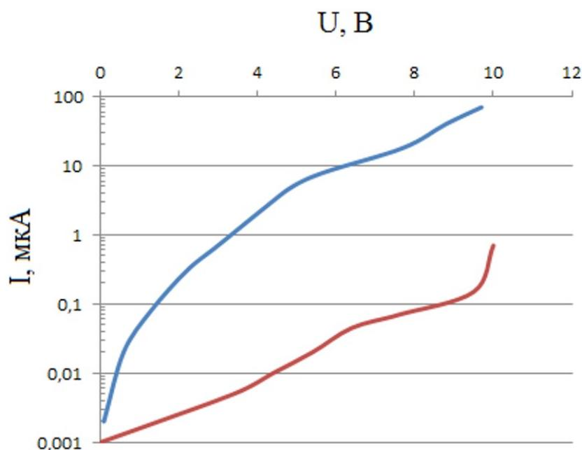
Рисунок 6 - Зависимость в логарифмическом масштабе для структуры на основе пленок оксида меди с примесями оксида титана, полученного методом магнетронного распыления составной мишени:
