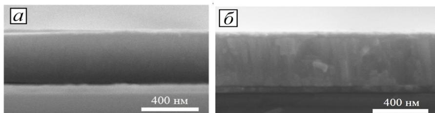
Рисунок 7 - РЭМ-изображение торцевого скола мемристивных структур без воздействия электрическим полем (а), после переключения в низкоомное состояние (б).
