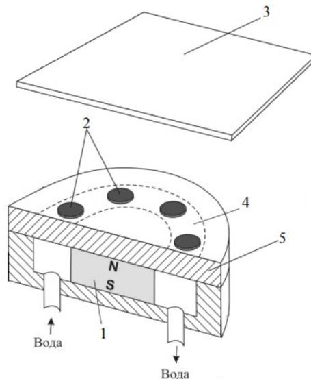
Рисунок 1 - Схематическое изображение магнетронной распылительной системы:
