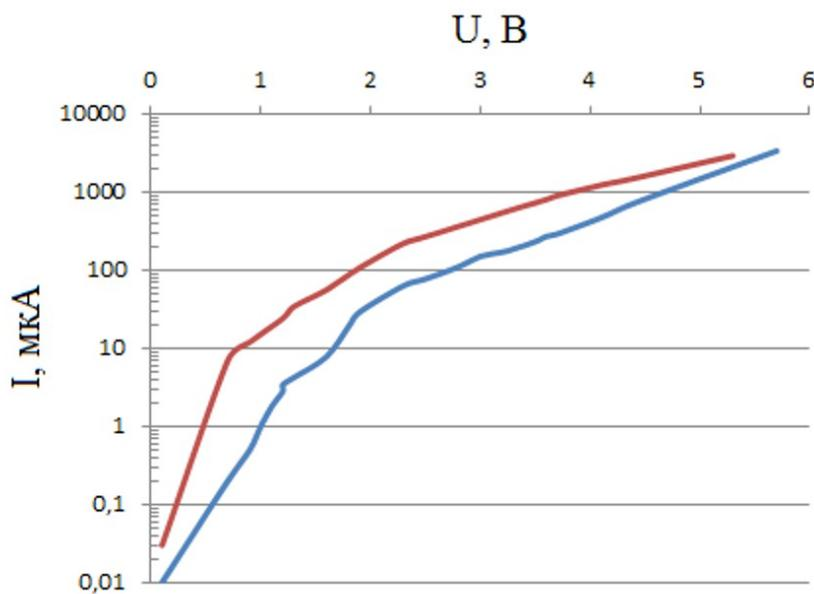
Рисунок 5 - Зависимость в логарифмическом масштабе для структуры на основе оксида титана:
