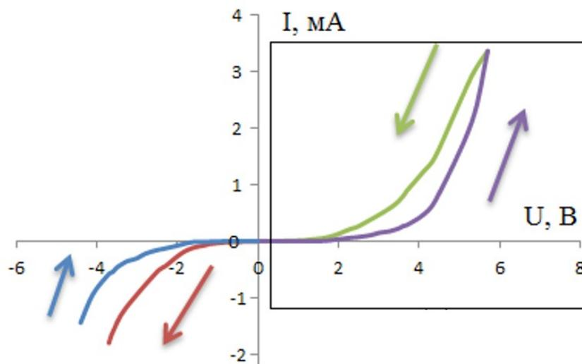
Рисунок 3 - Вольт-амперная характеристика структуры на основе оксида титана:
