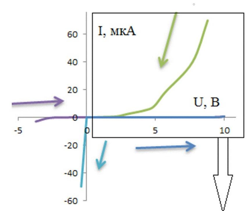
Рисунок 4 - Вольт-амперная характеристика структуры на основе пленок оксида меди с примесями оксида титана, полученного методом магнетронного распыления составной мишени:
