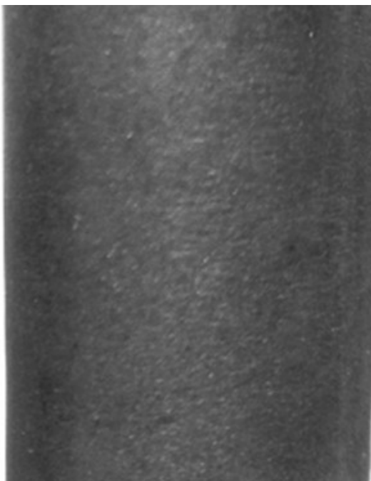
Рисунок 2 - Изображение боковой поверхности топливной таблетки из диоксида урана
