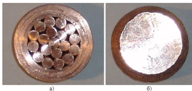
Рисунок 1 - Разрез соединения провода М-120 и медной втулки DOI: https://doi.org/10.23670/IRJ.2023.137.93.1
