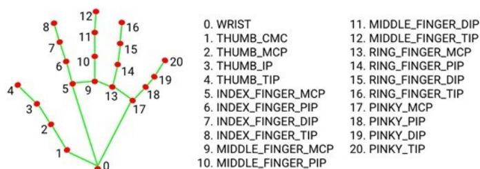
Рисунок 3 - Расположение опорных точек на поверхности ладони DOI: https://doi.org/10.23670/IRJ.2023.138.163.3
