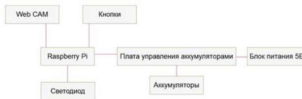
Рисунок 2 - Компонентная база аппаратной части DOI: https://doi.org/10.23670/IRJ.2023.138.163.2
