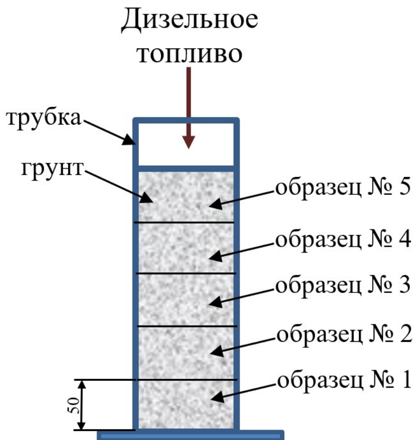
Рисунок 1 - Схема послойного извлечения образцов грунта со следами нефтепродукта DOI: https://doi.org/10.23670/IRJ.2024.139.14.1
