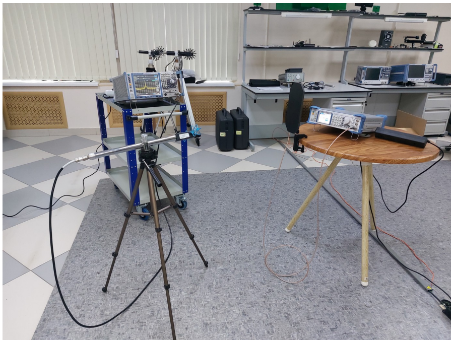
Рисунок 2 - Стенд для измерения значения уровня сигнала в опорной точке DOI: https://doi.org/10.23670/IRJ.2023.137.31.2
