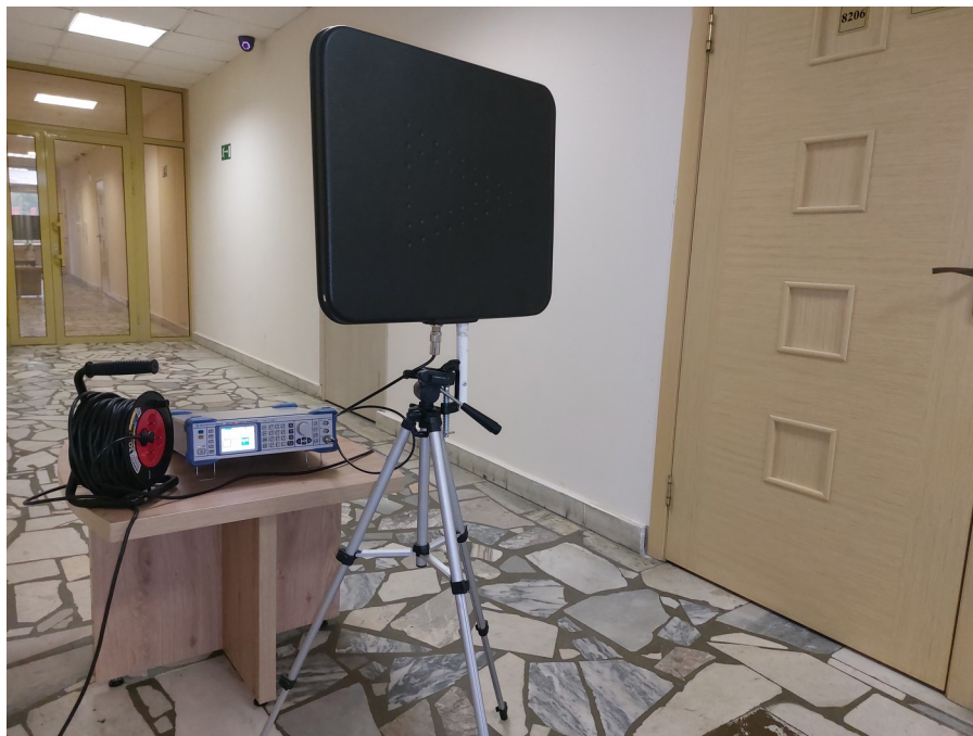
Рисунок 3 - Измерение затуханий в дверях (излучатель) DOI: https://doi.org/10.23670/IRJ.2023.137.31.4
