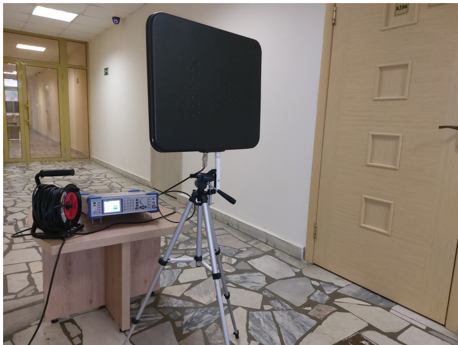
Рисунок 3 - Измерение затуханий в дверях (излучатель) DOI: https://doi.org/10.23670/IRJ.2023.137.31.4
