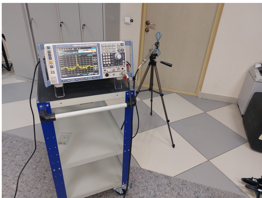
Рисунок 4 - Измерение затуханий в дверях (приёмник) DOI: https://doi.org/10.23670/IRJ.2023.137.31.5
