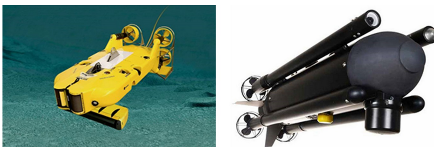
Рисунок 10 - Дистанционно управляемые подводные аппараты «Double Eagle», система проверки и обезвреживания мин «SeaFox» [18] DOI: https://doi.org/10.23670/IRJ.2023.137.21.11
