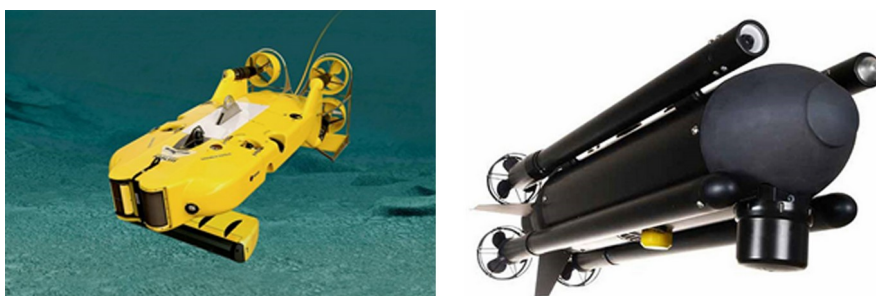
Рисунок 10 - Дистанционно управляемые подводные аппараты «Double Eagle», система проверки и обезвреживания мин «SeaFox» [18]
