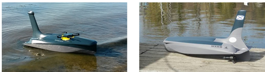
Рисунок 5 - Автономный надводно-подводный роботизированный комплекс «Глайдерон» [4]
