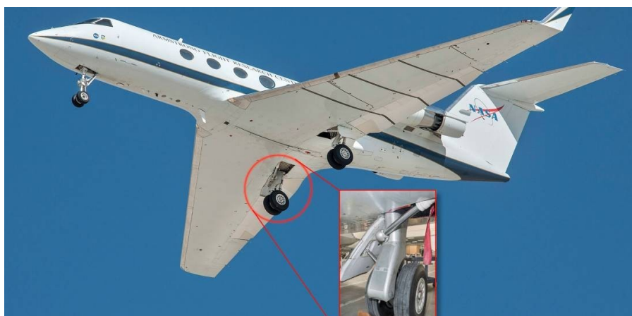
Рисунок 6 - Летающая лаборатория NASA Gulfstream GIII с гибким крылом и обтекателями стоек шасси DOI: https://doi.org/10.23670/IRJ.2023.135.45.6
