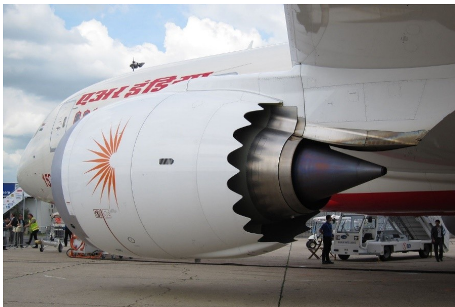
Рисунок 5 - Boeing 787 с применением пилообразных шевронов на двигателе для снижения уровня излучаемого шума DOI: https://doi.org/10.23670/IRJ.2023.135.45.5
