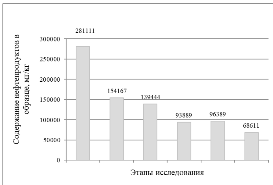
Рисунок 2 - Динамика изменения содержания нефтепродуктов в почве при действии второго состава компонентов смеси
