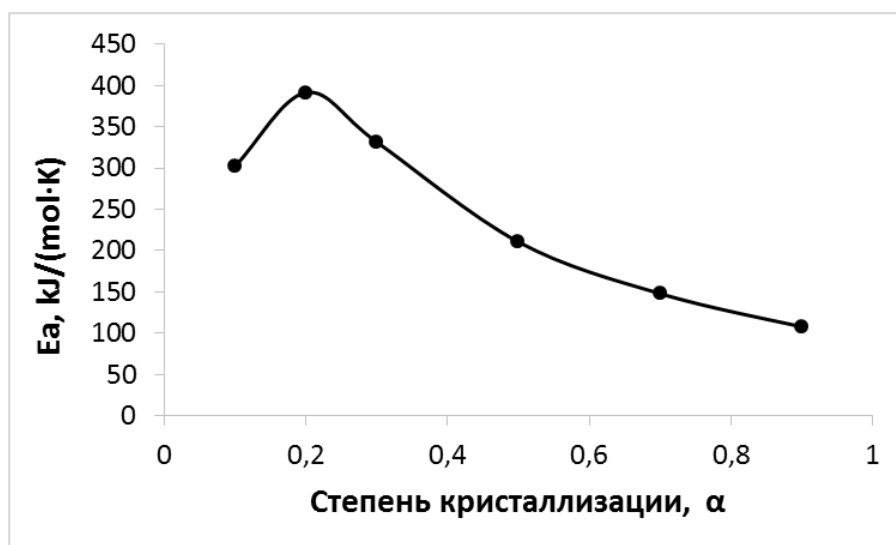
Рисунок 6 - Зависимость энергии активации процесса кристаллизации прекурсора от степени кристаллизации, полученная по результатам изоконверсионного анализа DOI: https://doi.org/10.23670/IRJ.2023.136.6.7
