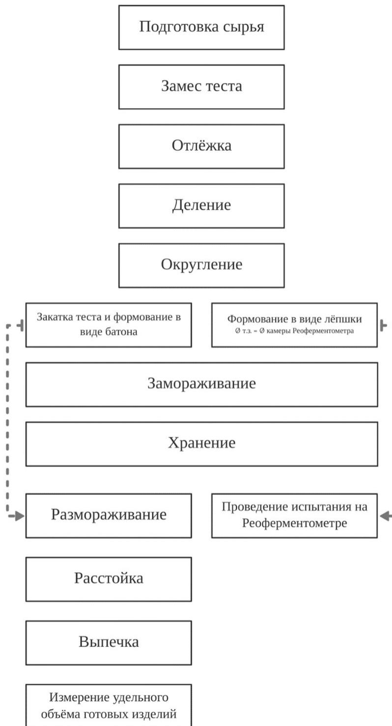
Рисунок 1 - Схема проведения экспериментальной части исследования
