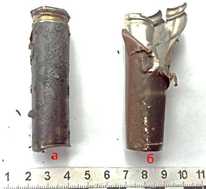
Рисунок 1 - Последствия разгерметизации литий-ионной аккумуляторной батареи после теплового разгона, возникшего внутри нее:
