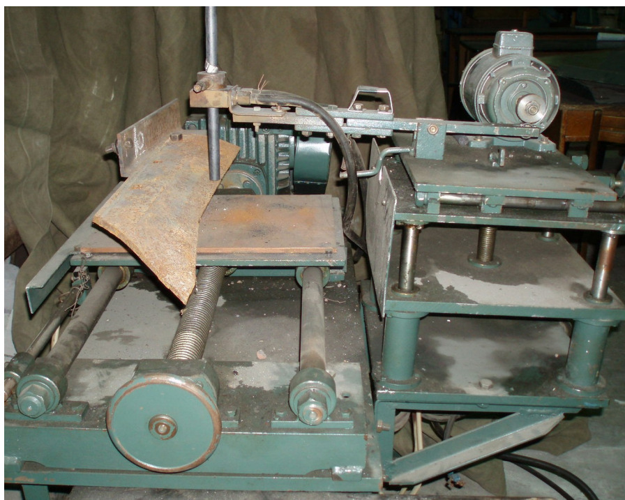
Рисунок 2 - Общий вид установки для борирования с одновременным науглероживанием
