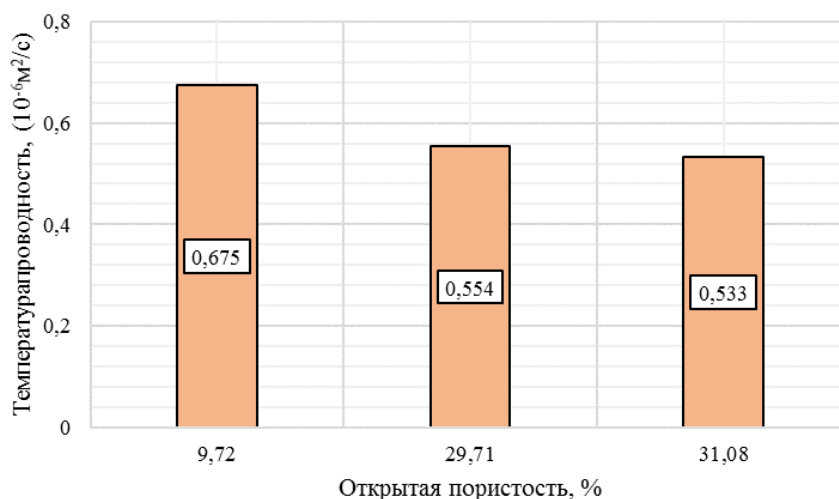
Рисунок 5 - График зависимости открытой пористости образцов керн от температуропроводности DOI: https://doi.org/10.23670/IRJ.2023.132.13.8
