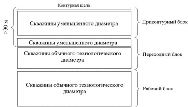
Рисунок 1 - Районирование параметров я буровзрывных работ вблизи предельного контура карьера DOI: https://doi.org/10.23670/IRJ.2023.129.39.1
