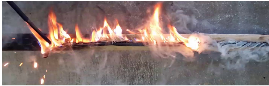
Рисунок 8 - Горение изоляции и саморегулируемая дуга на кабеле ВВГнг(А)-LS 3x1,5 DOI: https://doi.org/10.23670/IRJ.2023.127.84.8
