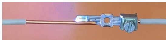
Рисунок 5 - Ординарное искрение между проводником и пластиной клеммы DOI: https://doi.org/10.23670/IRJ.2023.127.84.5
