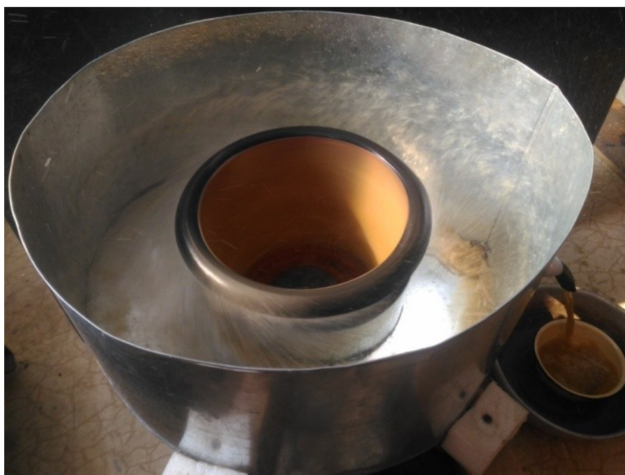
Рисунок 1 - Экспериментальный образец центробежной флотомашины с периферийной разгрузкой концентрата DOI: https://doi.org/10.23670/IRJ.2022.126.64.1
