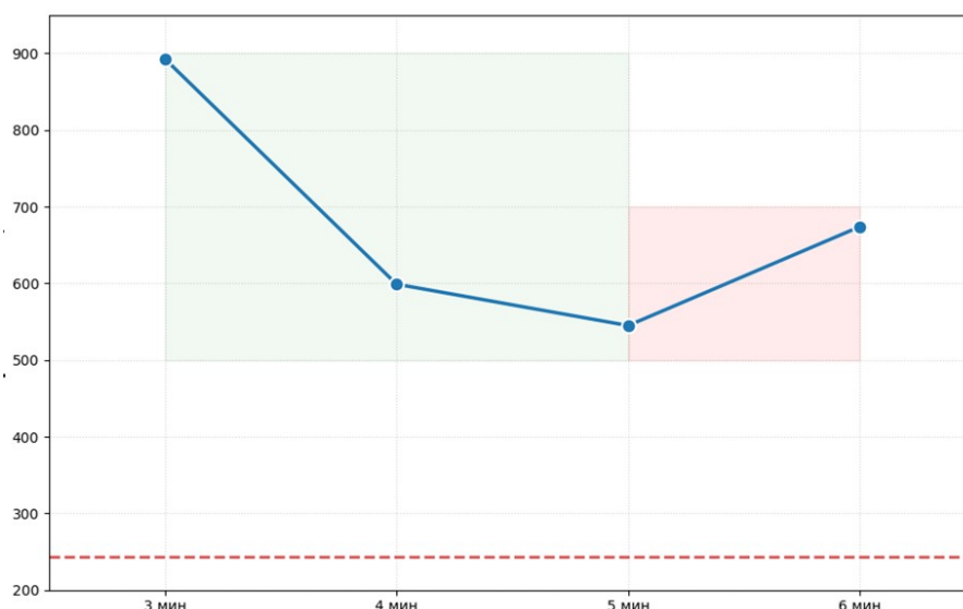
Рисунок 1 - Зависимость среднего статического сопротивления контакта Al-Si от времени изотермической выдержки при 600 °С. Точки — средние значения, усы — 95 % доверительные интервалы DOI: https://doi.org/10.60797/IRJ.2026.172.97.4
