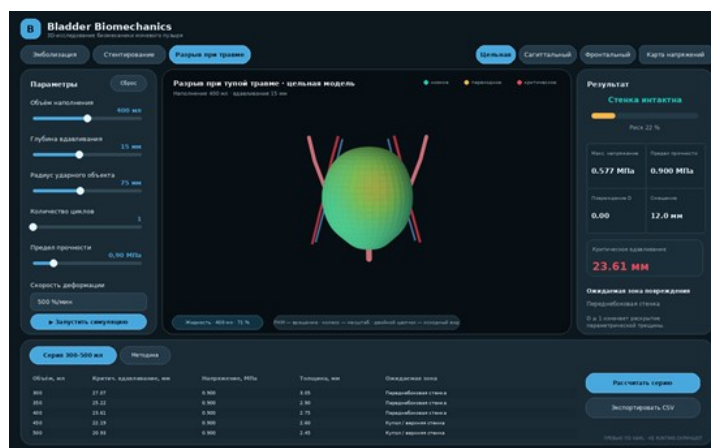
Рисунок 6 - Интерфейс приложения «Bladder Biomechanics». Цельная модель мочевого пузыря при объёме 400 мл DOI: https://doi.org/10.60797/IRJ.2026.171.18.7
