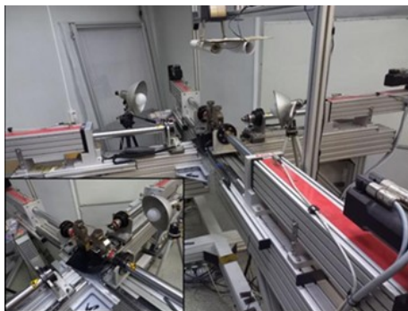
Рисунок 1 - Испытательная машина Zwick/Roell для определения механических характеристик материала DOI: https://doi.org/10.60797/IRJ.2026.171.18.1
