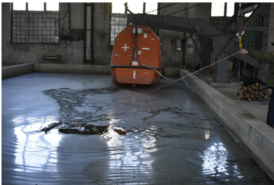
Рисунок 1 - Первичные испытания моделей ГДЯ в техническом бассейне с использованием блока на гаке шкентеля кран-балки и с ручной имитацией вертикального перемещения плота
