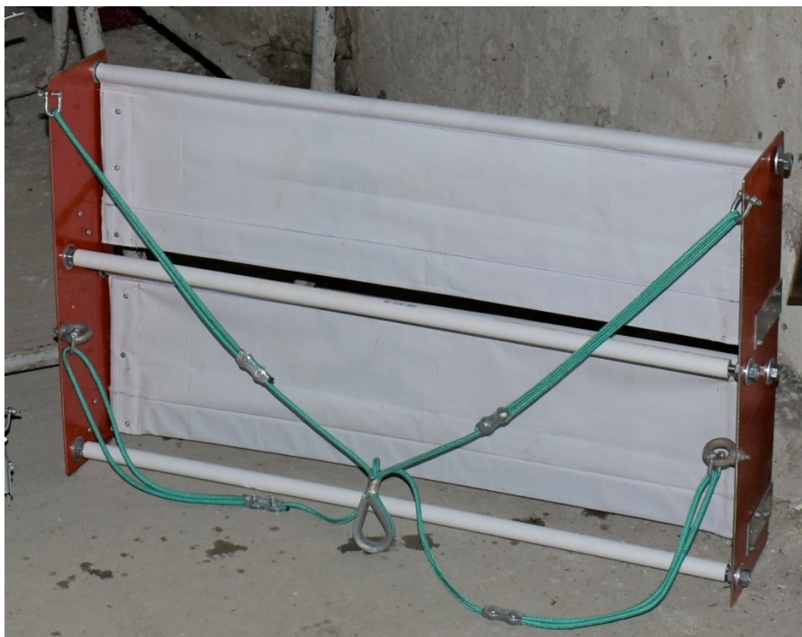
Рисунок 4 - Общий вид гидропарусной модели с продольными и поперечными латами
