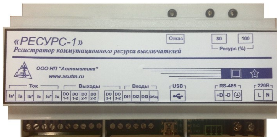
Рисунок 3 - Внешний вид регистратора коммутационного ресурса выключателя «РЕСУРС-1» DOI: https://doi.org/10.60797/IRJ.2026.170.56.3
