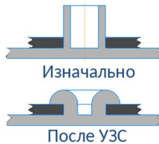
Рисунок 1 - Схема формирования сварочной точки DOI: https://doi.org/10.60797/IRJ.2026.168.120.1
