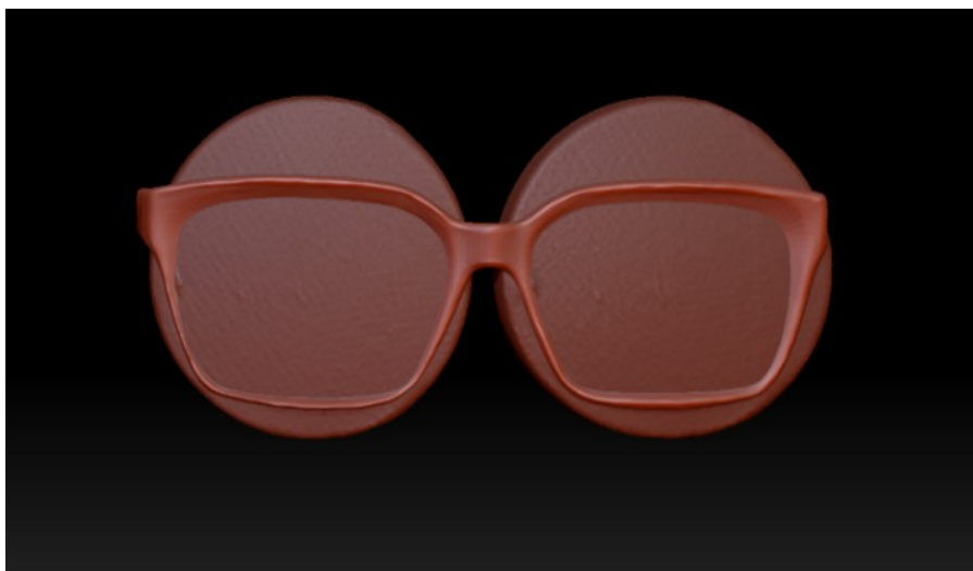
Рисунок 6 - Совмещение цифровых моделей линз и оправы при установке линз в световой проем оправы DOI: https://doi.org/10.60797/IRJ.2026.167.90.6
