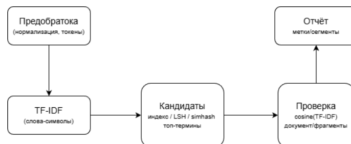
Рисунок 1 - Схема конвейера выявления дубликатов и плагиата на основе TF-IDF
