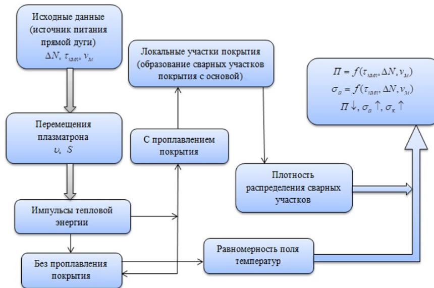
Рисунок 5 - Модель процесса модуляции прямой дуги плазматрона DOI: https://doi.org/10.60797/IRJ.2026.165.9.5
