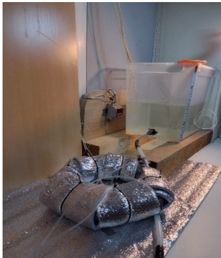
Рисунок 6 - Малогабаритный гидравлический стенд с терморегулятором, трубками-пьезометрами DOI: https://doi.org/10.60797/IRJ.2026.165.8.6
