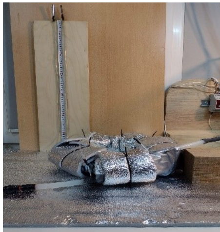
Рисунок 7 - Выборочные фрагменты малогабаритного гидравлического стенда с скрученным и помещенным в защитный кожух трубопровод и панно с мерной линейкой DOI: https://doi.org/10.60797/IRJ.2026.165.8.7
