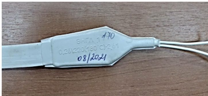
Рисунок 4 - Фрагмент греющего кабеля от терморегулятора DOI: https://doi.org/10.60797/IRJ.2026.165.8.4
