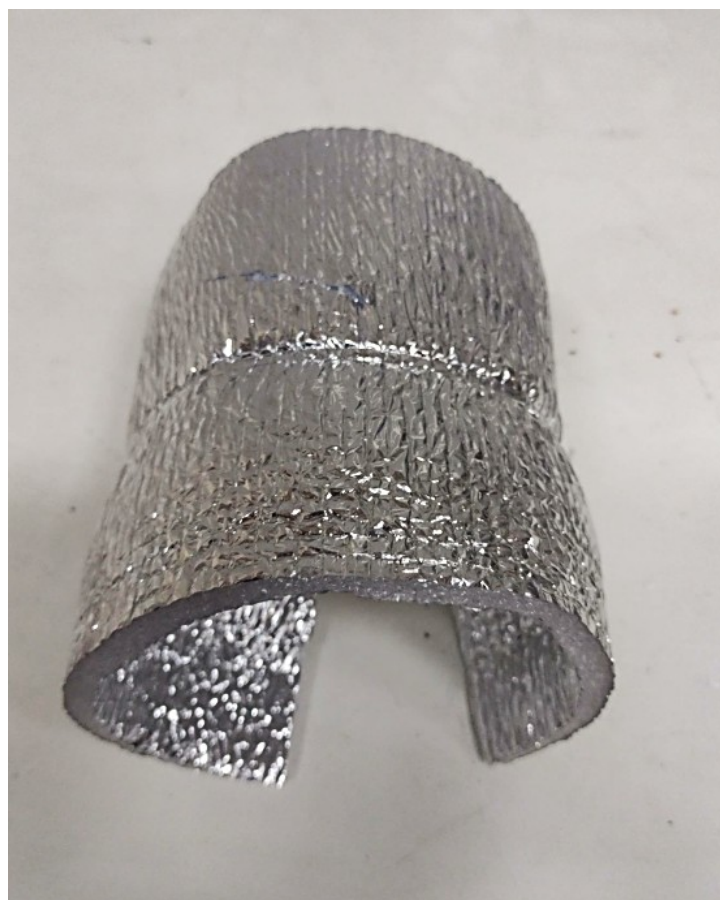
Рисунок 5 - Фрагмент защитного кожуха для витков DOI: https://doi.org/10.60797/IRJ.2026.165.8.5
