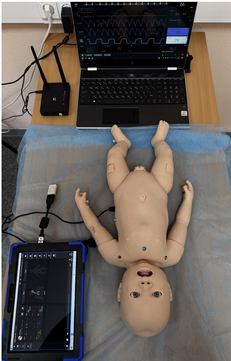
Рисунок 2 - Комплекс из манекена доношенного ребенка, компьютера оператора и монитора жизненных функций DOI: https://doi.org/10.60797/IRJ.2025.161.58.2
